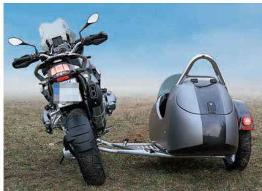
Ein Schwenker-Umbau ist günstiger, fahrphysikalisch nicht so eigen, und Solobetrieb nach schneller Umrüstung jederzeit möglich.
