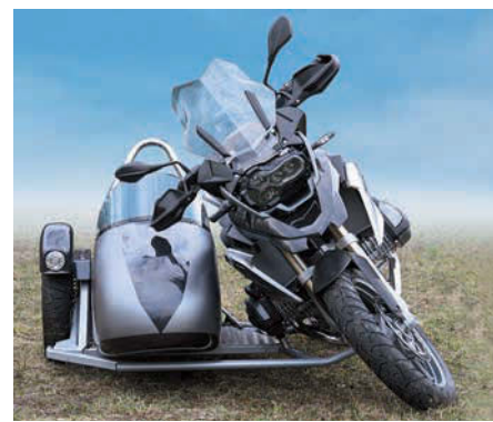
Ein Schwenker-Umbau ist günstiger, fahrphysikalisch nicht so eigen, und Solobetrieb nach schneller Umrüstung jederzeit möglich.
